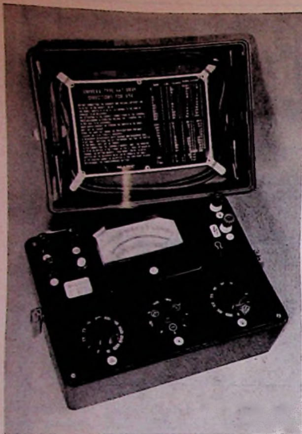
Draagbare draaispoel stroom-, spannings- en weerstandsmeter met metaalgelijkrichter Type UNIVEKA 147 URAV
